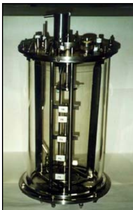
Figura 7: Modelo de biorreator utilizado para tratamento de borras de refinaria (Fonte: URURAHY, 1998).
