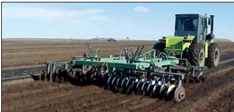
Figura 6: Revolvimento do solo durante aplicação de tecnologia landfarming . (Fonte: Desler Ingeniería y Servicios Ambientales. Acesso 11-01-2009. www.desleronline.com ).
